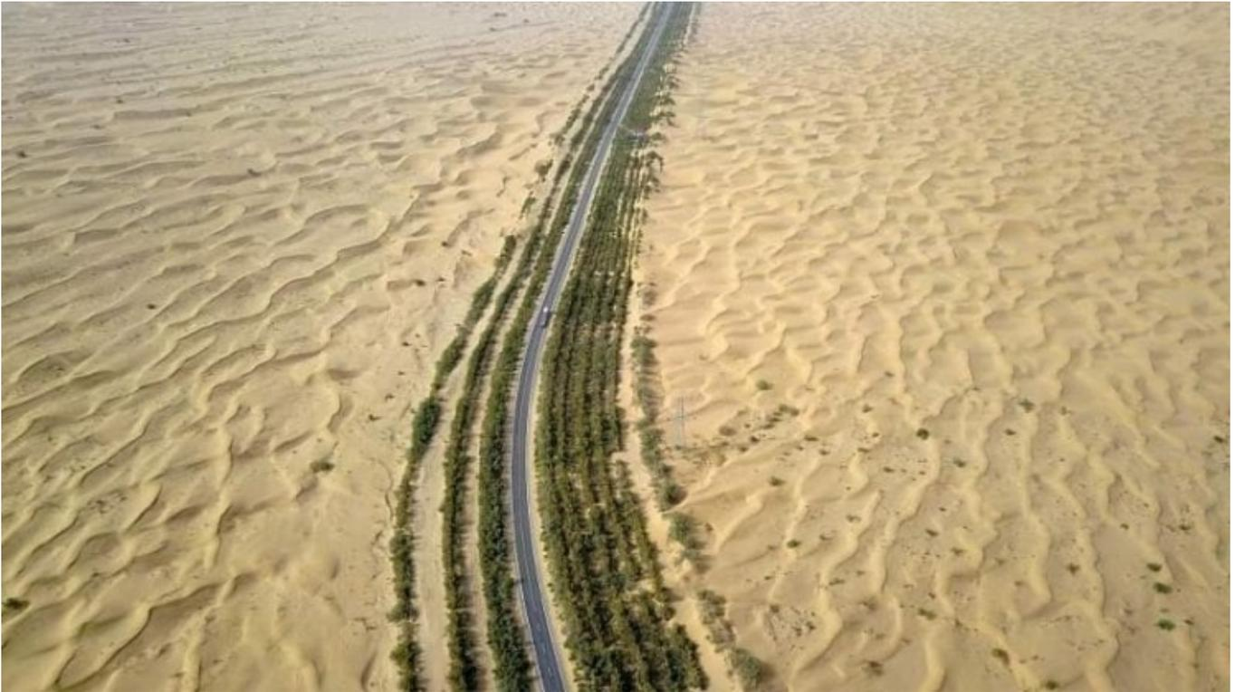
建于1995年的塔克拉玛干沙漠公路，全长552公里，穿越世界第二大流动沙漠。两旁的绿化带采用滴水灌溉，防止公路被沙漠吞没。（出处：[Instagram](#)）
